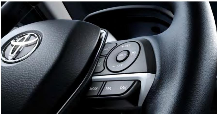
Avec le régulateur de vitesse au volant, vous n'avez pas besoin de relâcher les mains pour modifier les paramètres.
