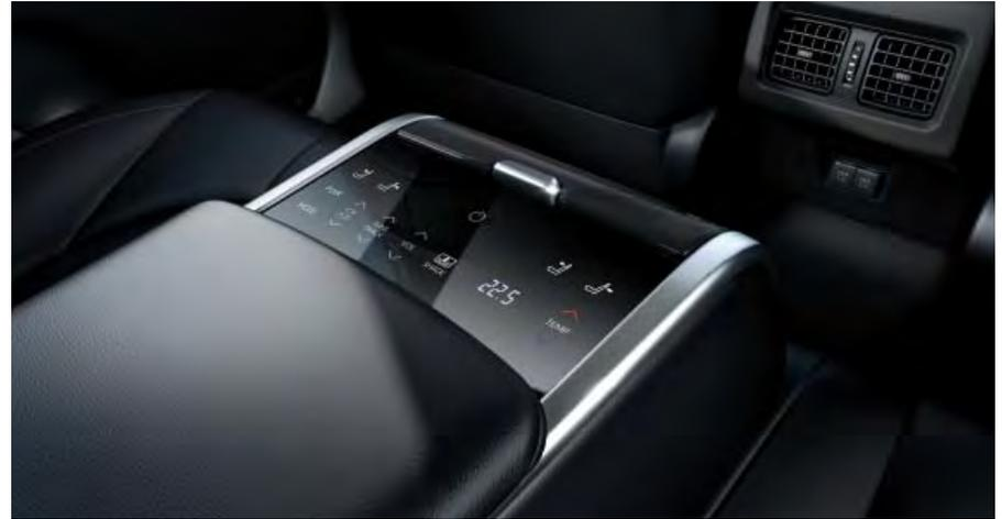
Un panneau de commande multifonctions dans la console centrale arrière permet d'accéder aux réglages de musique, d'inclinaison des sièges et de climatisation.
