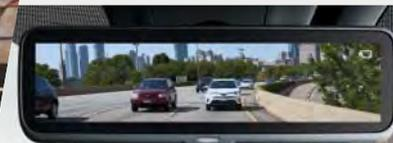
Le nouveau rétroviseur numérique offre au conducteur une meilleure vue d'ensemble de son environnement. Il vous suffit d'appuyer sur un bouton pour que le rétroviseur intérieur à atténuation automatique se transforme en rétroviseur numérique haute définition. Et puisqu'il utilise une caméra fixée en hauteur sur le pare-brise arrière du RAV4, l'écran vous garantit une vue dégagée, même lorsque des objets placés dans le coffre masquent votre visibilité.
