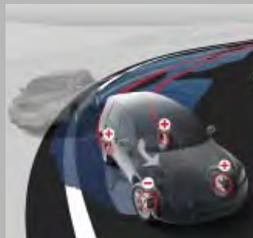
**Vehicle Stability Control (VSC)** active un freinage ciblé sur chaque roue et contrôle la puissance du moteur pour conserver au véhicule sa stabilité. Cela peut éviter un dérapage, par exemple dans un virage sur route glissante.
