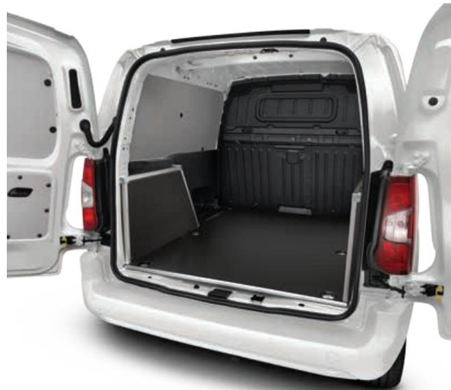
Protégez l'espace de chargement du véhicule. Les parois latérales sont en polypropylène et le sol en bois d'une épaisseur de 12 millimètres.
