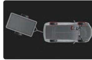
**Trailer Sway Control (TSC)** TSC supprime tout lacet de votre attelage causé par le vent, les mauvais revêtements ou le changement brusque de direction, etc quand vous tirez une remorque. Avec ces capteurs de détection de lacet, d'accélération et de direction, TSC contrôle la décélération et le moment de lacet afin de limiter le balancement. L'indicateur de VSC avertit lorsque le système TSC est activé et les feux stop sont allumés afin d'alerter les automobilistes qui vous suivent.
